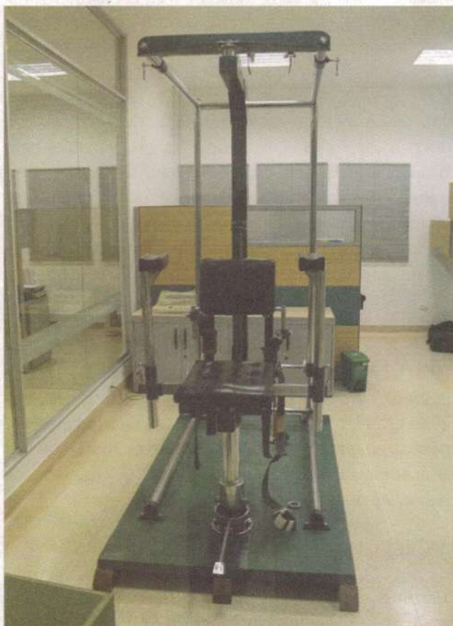
Figura 1. Dinamómetro isométrico digital TakeyKikyKoygo, del Laboratorio de Fisiología del Ejercicio de la Asesoría de Medicina Deportiva de Indeportes - Antioquia.
